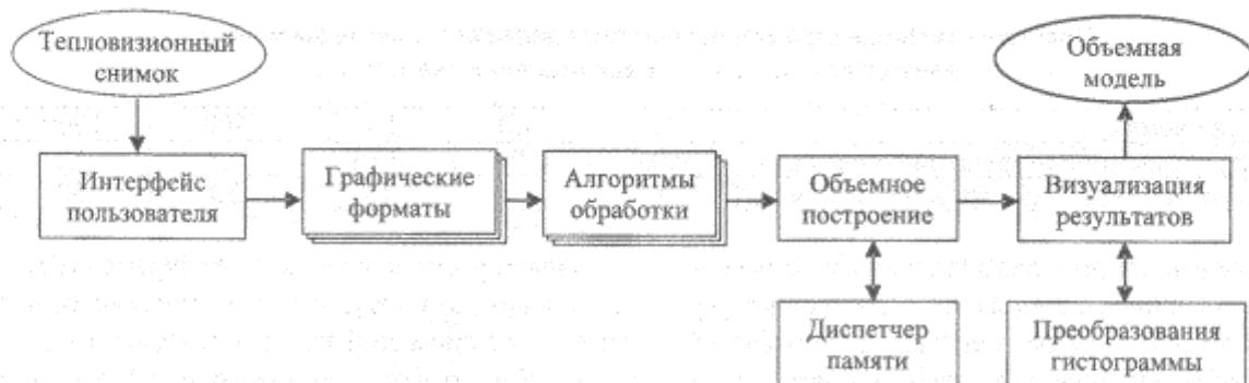
Рис. 1. Схема программного комплекса
